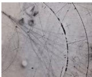
*Teilchenereignisspuren im LEBC Experiment, LEXan Blasenkammer, installiert im Nordareal des Super-Protonen-Synchrotron-Beschleunigers, CERN, Genf, Schweiz, 09.12.1981*
